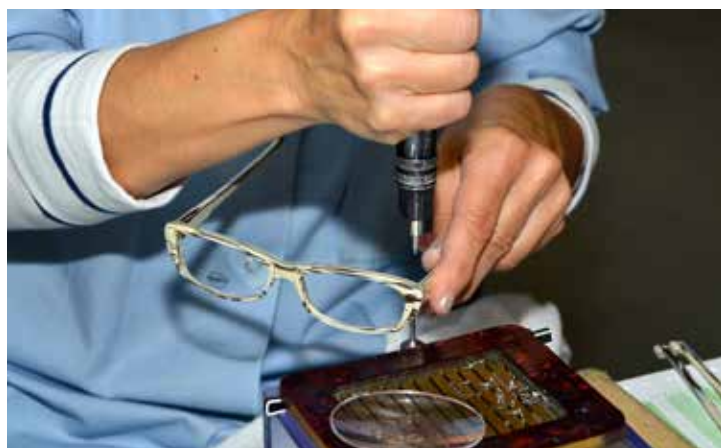
Le vissage des branches sur les faces est réalisé à la main.
